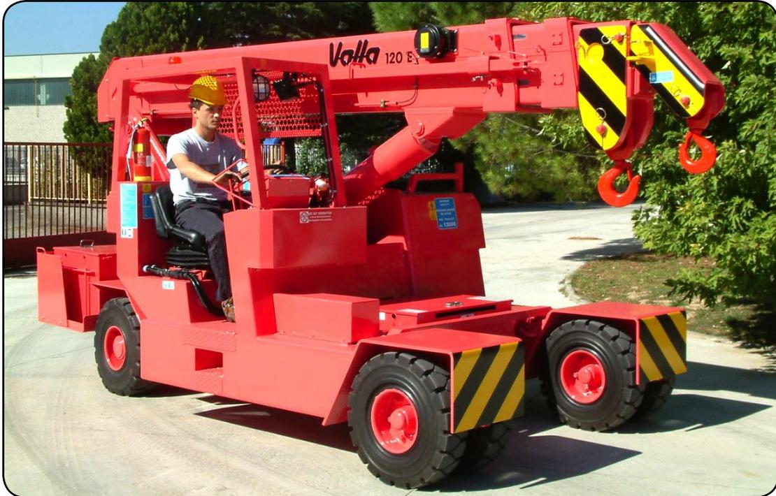
**CHASSIS:** construit à partir de plaques d'acier soudées, de haute qualité et contrepoids intégré.
