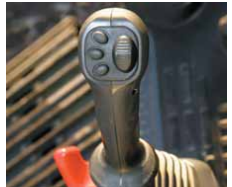
Joystick-hallintavivut, joissa proportionaaliset hallintapainikkeet työlaitteita varten
