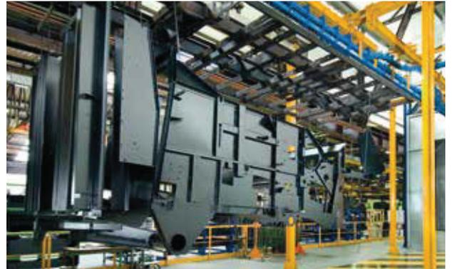
Das Lackieren der Teile erfolgt in einem ausgeklügelten Kataphorese-Verfahren, das heißt die einzelnen Teile durchlaufen nacheinander 14 unterschiedliche Tauchbäder, angefangen bei der Reinigung über die Polarisierung bis hin zur endgültigen Lackierung.
