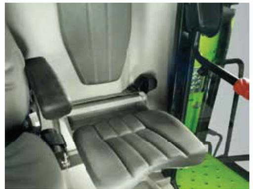
Ergonomischer Sitz mit mechanischer oder pneumatischer Verstellung, mehrfach verstellbares Lenkrad für maximalen Bedienkomfort.
