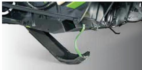
Mit den Tastkufen erkennt das Schneidwerk Bodenunebenheiten, woraufhin die Position sofort angepasst wird.
