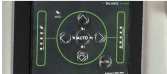
Das Balance-System ermöglicht den Hangausgleich der gesamten Maschine bis zu 20% Seitenneigung und bis zu 6% Steigung bzw. Gefälle. Dabei wird der gesamte Mähdrescher automatisch immer waagrecht bzw. horizontal gehalten.
