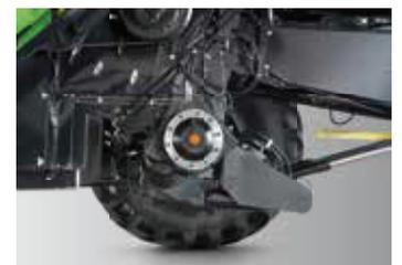
Sowohl die Balance- als auch die Standardachsen haben Untersetzungsgetriebe mit einer Tragkraft von 25 Tonnen, die es auch unter erschwerten Bedingungen ermöglichen, mit maximaler Sicherheit zu arbeiten.
