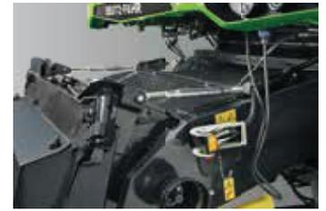
Die Schnittwinkelverstellung ermöglicht eine perfekte Anpassung an alle Bodenebenenheiten.
