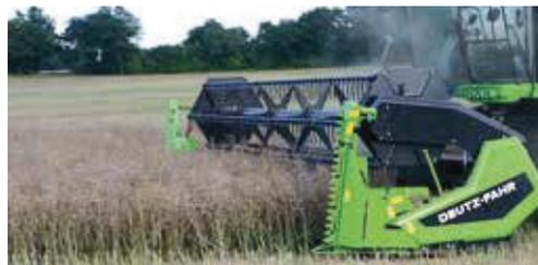
Der Rapsvorsatz lässt sich einfach an das Schneidwerk anbauen und erhöht dadurch die Flexibilität der Maschine.
