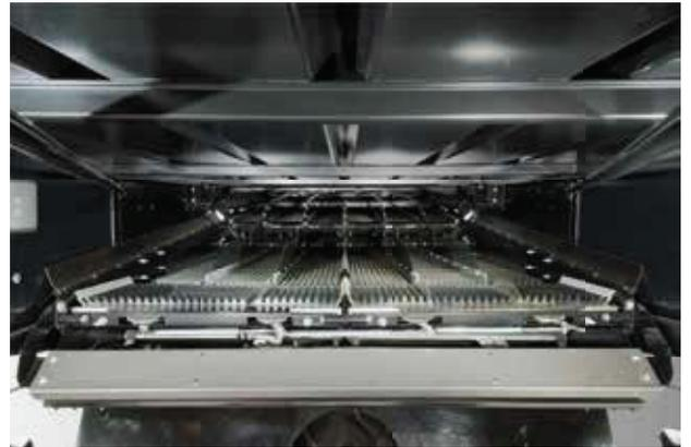
Die elektrische Siebverstellung (optional) für die Ober- und Untersiebe ermöglicht die sofortige Anpassung an alle Erntebedingungen.
