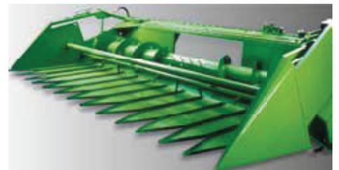
Der Sonnenblumenvorsatz ermöglicht die Ernte der Sonnenblumenkörbe und optimiert dadurch die Dreschleistung.
