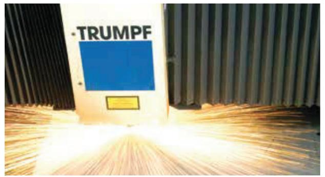
Jedes Konstruktionsteil der Maschine wird – ausgehend vom 3D-Modell – mit Lasergeräten ausgeschnitten und anschließend bearbeitet.
