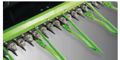
Die wechselweise montierten Mähklings verringern den Verschleiß und garantieren immer einen optimalen Schnitt.
