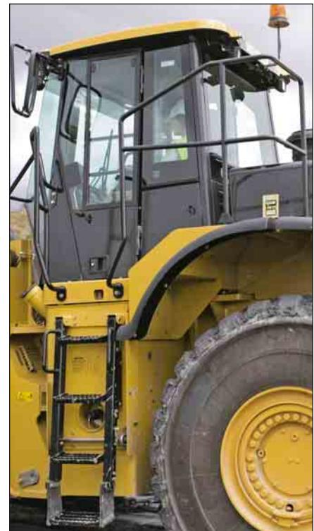
**Органы управления.** В погрузчике 980Н основная панель управления располагается достаточно высоко на правой стойке устройства защиты при опрокидывании ROPS. С одной стороны, все органы управления под рукой, с другой – панель не мешает обзору. Удобное расположение органов управления и переключателей обеспечивает высокую эффективность и производительность работы оператора, снижает его утомляемость.
