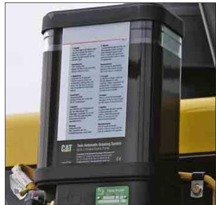
**Автоматическая централизованная система смазки.** Устанавливаемая по заказу автоматическая централизованная система смазки Caterpillar позволяет сэкономить время на ежедневном обслуживании и избежать непредвиденных простоев из-за неполадок, связанных с недостаточной смазкой. Регулярная смазка пальцев и втулок точным количеством масла уменьшает износ деталей. Помимо этого грунт меньше загрязняется избыточными смазочными материалами.
