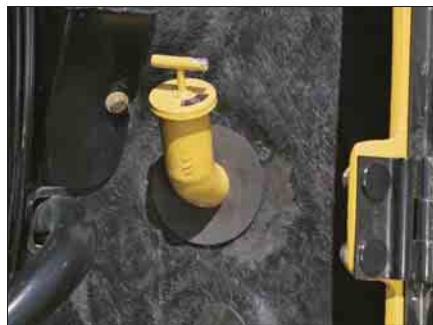
В боковых стенках капота имеются откидные крышки, открывающие доступ к визуальным указателям. Проверить уровни моторного масла и охлаждающей жидкости можно, не откidyвая капот.
