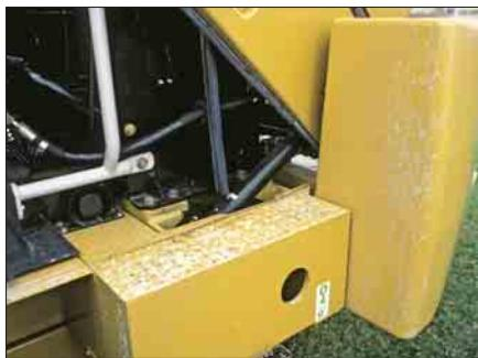
Откидной капот обеспечивает свободный доступ к моторному отсеку. При необходимости капот можно снять полностью – для этого он оборудован специальными проушинами.
