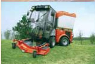
**Geschwindigkeiten:** Fahrgeschwindigkeit automotiv 0-25 km/h, Arbeitsfahrt hydrostatisch 0-13 km/h, Rückwärtsfahrt 0-12 km/h.
