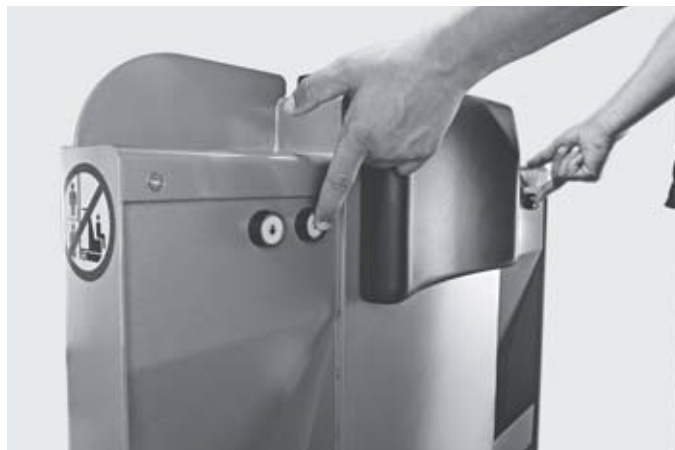
Надежное двуручное управление дополнительным подъемом модели COP-L 07
