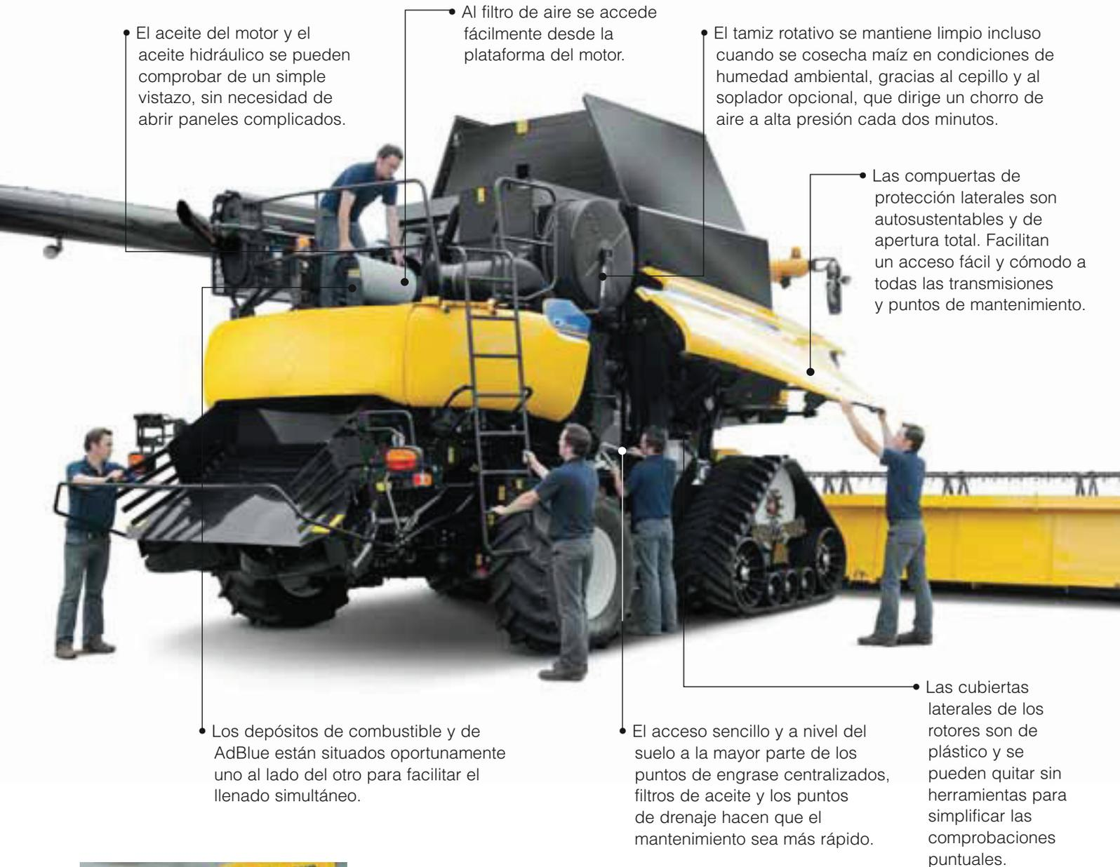
• El aceite del motor y el aceite hidráulico se pueden comprobar de un simple vistazo, sin necesidad de abrir paneles complicados.
