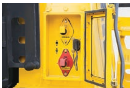
Caisson batterie et isolateur de démarreur (optionnel pour les modèles d'exploitation minière) avec prise pour démarrage par câbles volants.
