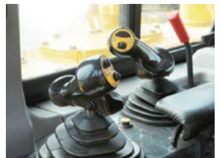
Levier de contrôle de la lame avec contrôle automatique de l'angle d'attaque et nouveau levier de contrôle du ripper avec relevage automatique du ripper
