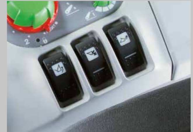
... Bedienelemente für den Frontladerbetrieb sind voll integriert und leicht zu erreichen.
