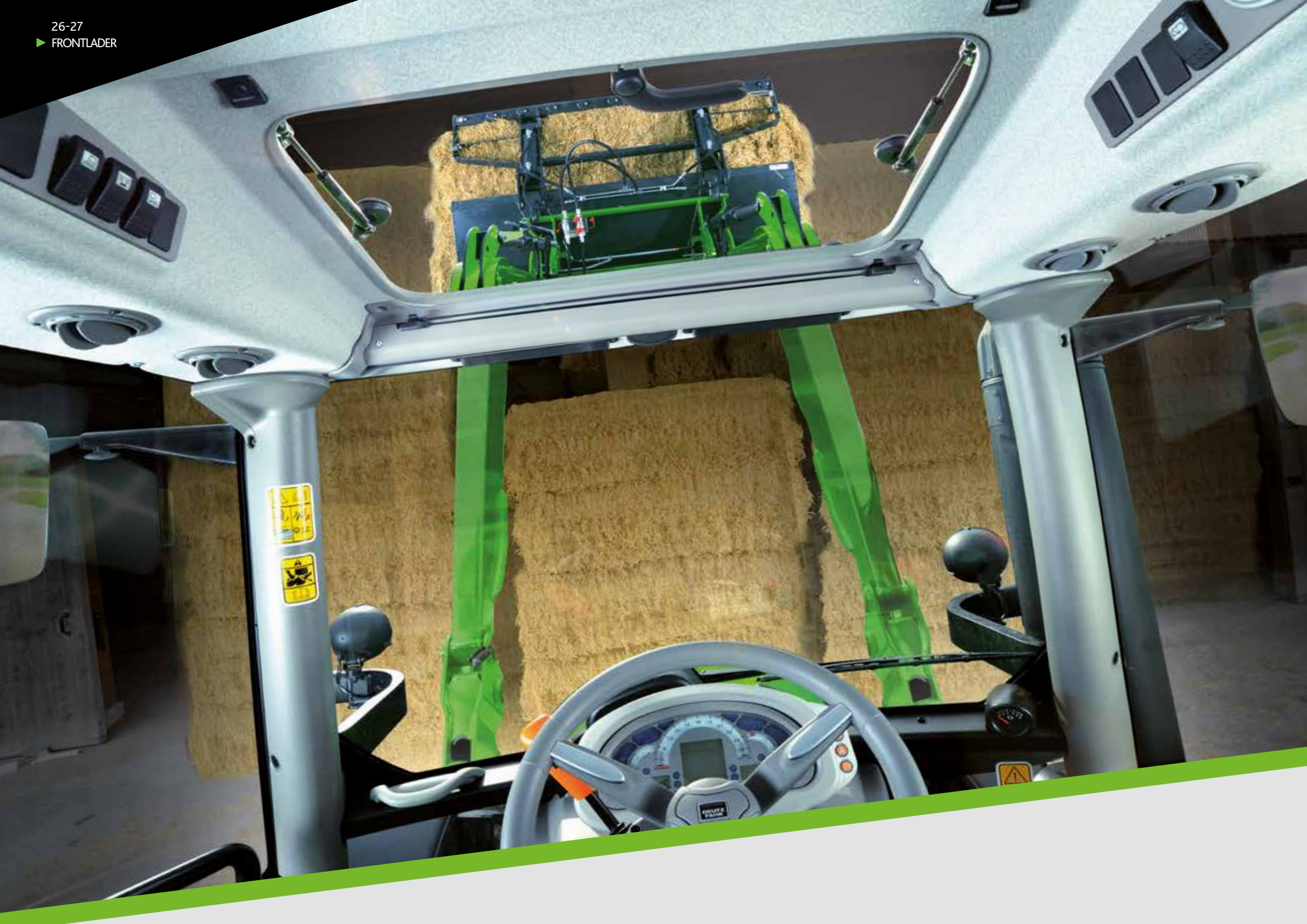
Frontlader-Joystick mit Powershift Knöpfen. Stop&Go und SDD Schnelllenksystem und alle...
