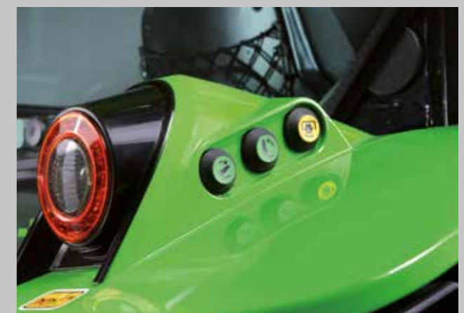
Externe Zapfwellen- und Kraftheberbedienung für leichtes Geräteankoppeln und den externen Zapfwellenbetrieb.
