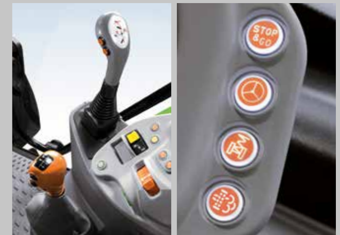
Frontlader-Joystick mit Powershift Knöpfen. Stop&Go und SDD Schnelllenksystem und alle...
