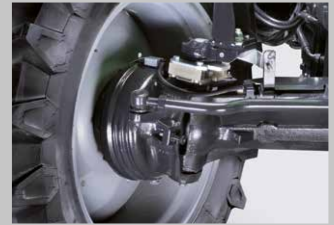
Einzigartiges Sicherheitskonzept von DEUTZ-FAHR. Separate im Ölbad gekühlte Scheibenbremsen an den Vorderrädern.
