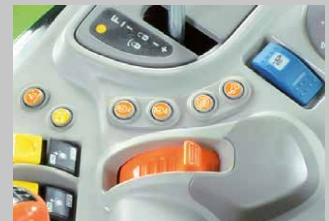
Neu: Zwei Motordrehzahlenspeicher. Effizienz für Routinearbeiten vorprogrammiert.
