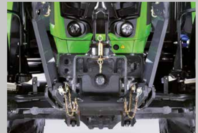
Frontanbauräum. 2100 kg Hubkraft und 1000er Zapfwelle.
