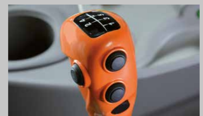
Comfort Clutch und Powershift. Einfach per Knopfdruck schalten ohne zu kuppeln.
