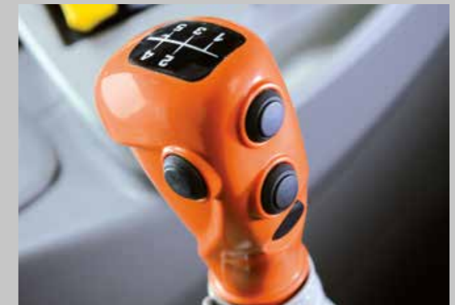
Gangwechsel über Bowdenzüge und Knopfdruck jetzt noch komfortabler.
