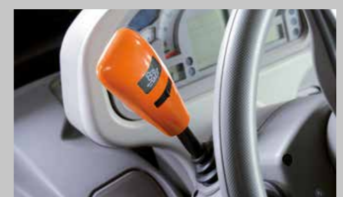
Powershuttle serienmäßig. Elektrohydraulische Wendeschtaltung in 5 Stufen einstellbar.
