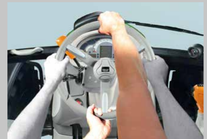
Das SDD Schnelllenksystem. Halbe Lenkraddrehung, doppelter Lenkeinschlag.
