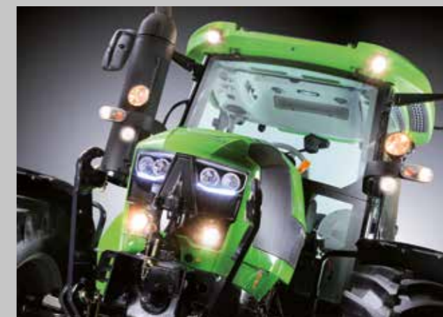
Das Scheinwerferpaket. Für beste Sicht bei schlechter Sicht. Acht Arbeitsscheinwerfer im Dach und an den Seitenholmen. Zwei Arbeitsscheinwerfer und zwei LED-Leuchten in der Motorhaube.
