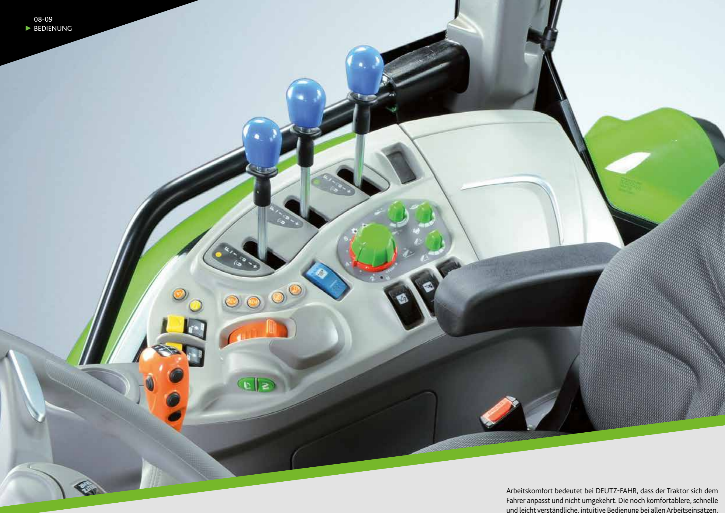
Gangwechsel über Bowdenzüge und Knopfdruck jetzt noch komfortabler.
