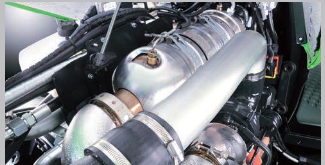
... e un catalizzatore DOC (diesel oxidation catalyst) garantiscono emissioni minime.
