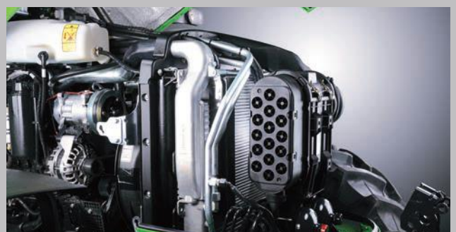
... e lo stesso si può dire del sistema di raffreddamento con ventola viscostatica (opzionale), facile da pulire.
