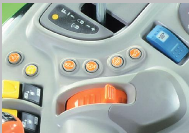
Novità: due impostazioni per la velocità del motore. Efficienza pre-programmata per operazioni di routine.
