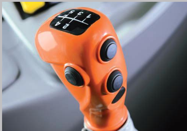
I tiranti Bowden hanno reso il cambio marcia ancora più comodo: è sufficiente premere un pulsante.
