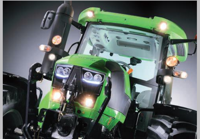
Il pacchetto luci. Per una visuale ottimale quando la visibilità è scarsa. Otto fari di lavoro posti sul tetto e sui montanti laterali. Due fari di lavoro e due luci LED sul cofano.
