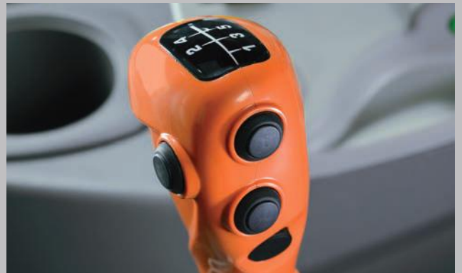
ComfortClutch e Powershift. Cambiare marcia con la semplice pressione di un pulsante e senza azionare la frizione.
