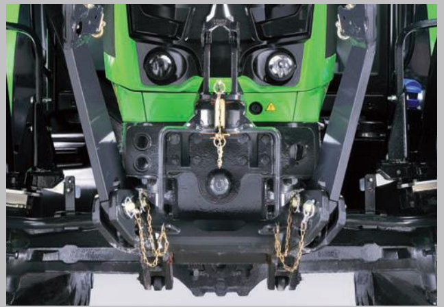
Attacco a 3 punti anteriore. Capacità di sollevamento da 2100 kg e 1000 PTO.
