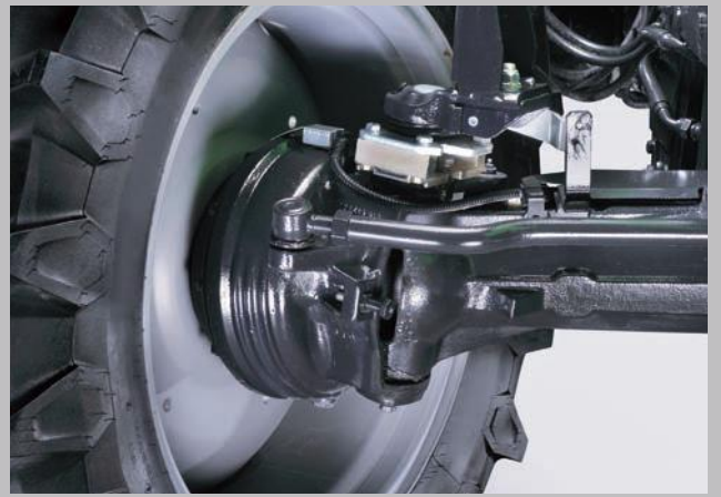
Un concetto di sicurezza esclusivo targato DEUTZ-FAHR. Freni a disco separati raffreddati a olio sulle ruote anteriori.
