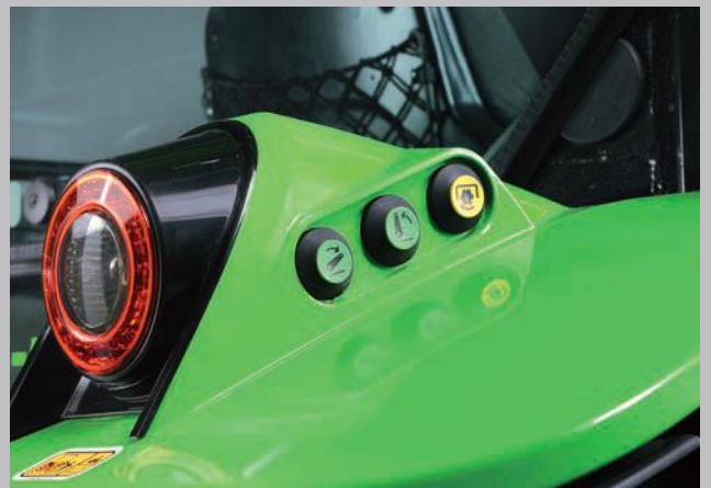
Comandi esterni della presa di forza e del sollevatore posteriore.
