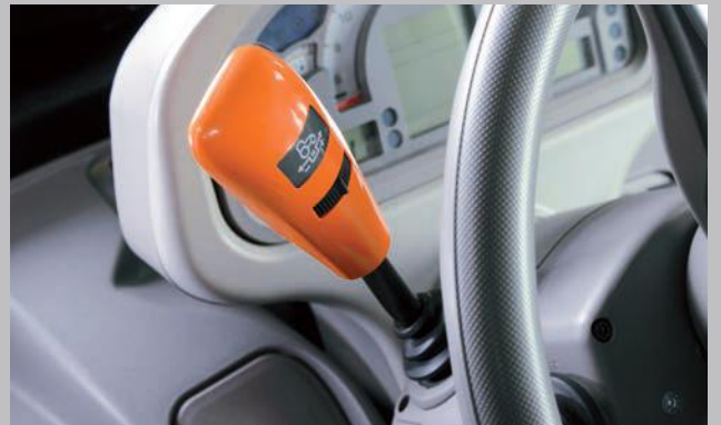
PowerShuttle di serie. Inversore elettro-idraulico con cinque stadi regolabili.
