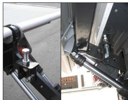
**S412** **S424** Anschlag für die Hubarme gegen Chassis
