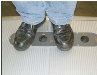
**S006** 4-Punkt Fußsteuerung in der Plattform montiert
