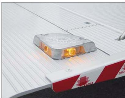
**S090** LED Warnblinkleuchten auf der Plattform montiert
