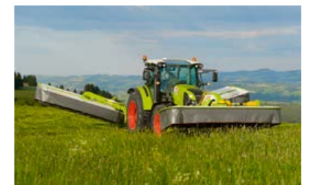
Door de compacte ophanging aan de fronthead beschikt de maaier over veel bodemvrijheid op de kopakker.
