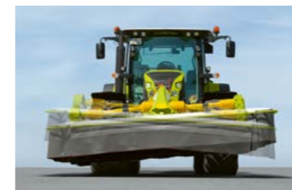
Dopasowanie poprzeczne do kierunku jazdy na swobodnym zawieszeniu wahadłowym.
