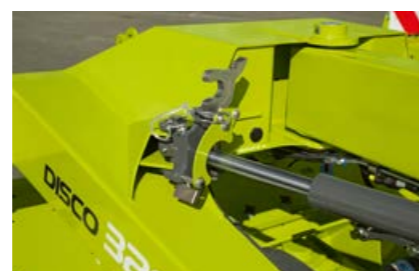
Elastyczność: przestawianie dyszla i dopasowania do różnych ciągników (opcja)
