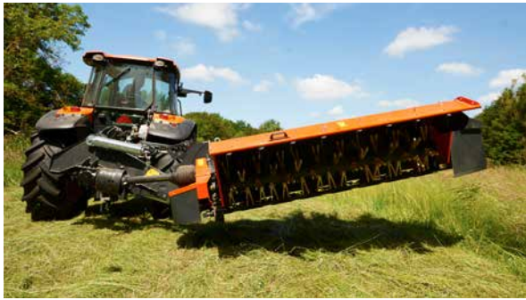
Relevage hydraulique intégré pour faciliter le relevage en bout de champ.
