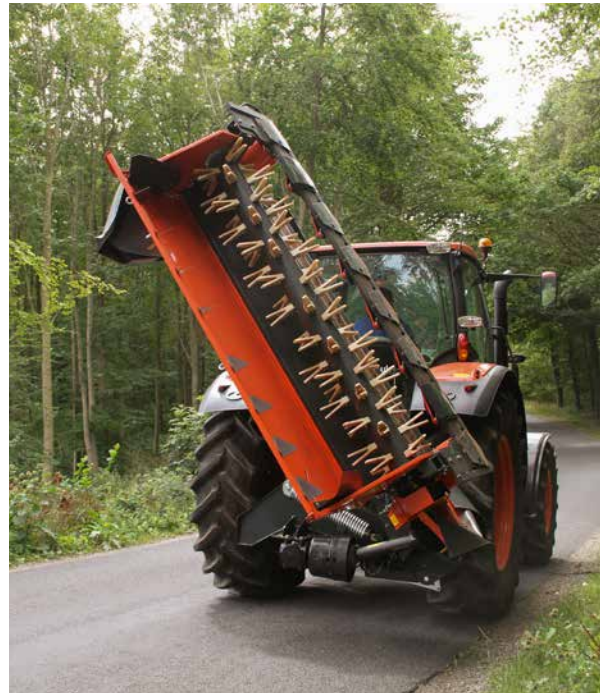
Relevage hydraulique intégré pour faciliter le relevage en bout de champ.
