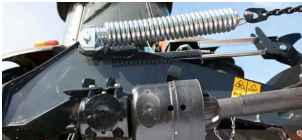
2 vitesses de rotation – Il suffit de tourner de 180° le boîtier d'entraînement.
