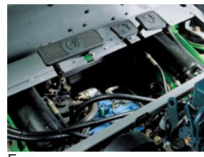
El alojamiento de la dirección asistida hidráulica, debajo de la plataforma, permite obtener una simplificación de las conexiones y reducir los ruidos de marcha. La racional disposición de los componentes en el interior del chasis facilita el acceso a los mismos permitiendo un rápido y eficaz mantenimiento.
