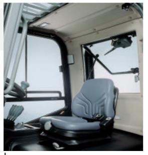
La nueva cabina completa, disponible como opción se monta en el interior del perfil de las barras de protección. En su configuración estándar está equipada con revestimientos, accesorios y cuidadas insonorizaciones, techo en lexan con canalones, cristal corredizo y limpiaparabrisas de pantógrafo.
