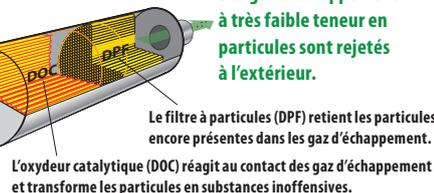
Le filtre à particules (DPF) retient les particules encore présentes dans les gaz d'échappement.
