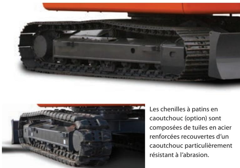
Les chenilles à patins en caoutchouc (option) sont composées de tuiles en acier renforcées recouvertes d'un caoutchouc particulièrement résistant à l'abrasion.
