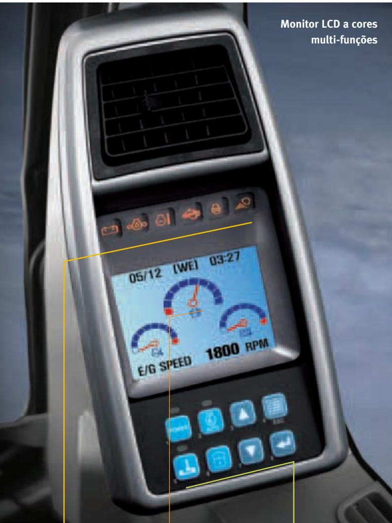
Monitor LCD a cores multi-funções
