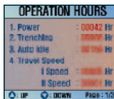
Betriebsstundenanzeige in den versch. Betriebsbereichen
