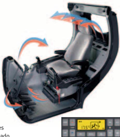
O ar condicionado de elevado rendimento proporciona um fluxo de ar que pode ser regulado e controlado electronicamente de acordo com as condições climáticas. Está equipado com cinco modos de operação, que satisfazem os operadores mais exigentes.
