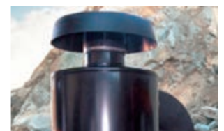
Oliegewassen luchtfilter Verbeterd de reiniging van de luchtinlaat in extra stoffige omgevingen zoals steengroeves.
