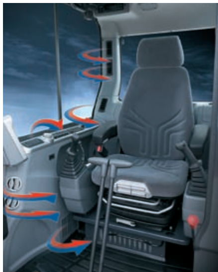
Grote uitvoer van de airconditioning en de verwarming
