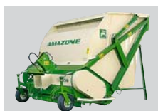
Tosaerba Grasshopper con contenitore a svuotamento dall'alto
