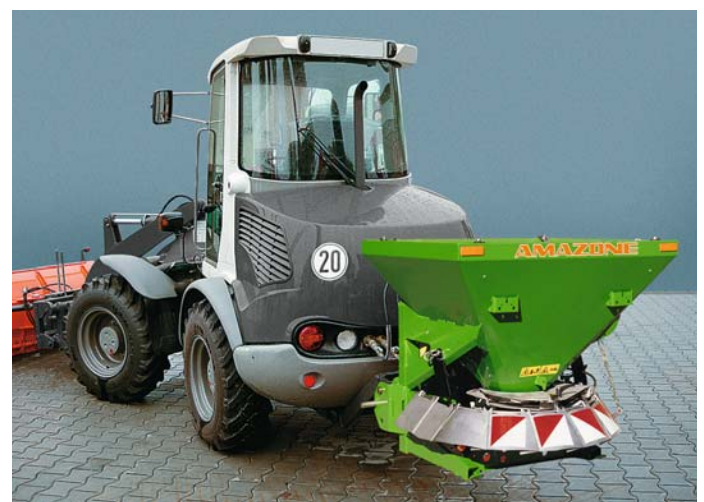
E+SH: L'azionamento con motore idraulico consente ad esempio l'utilizzo del trattore con una pala gommata.
