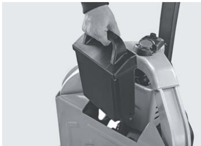
Disponibilité maximale grâce à une batterie Li-ion avec possibilité de charge d'appoint rapide
