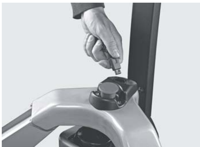
Haute sécurité grâce à un système exclusif de démarrage sans clé empêchant tout accès non autorisé
