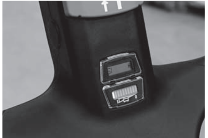
Visualizzazione chiara delle condizioni della batteria e delle ore di funzionamento
