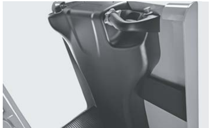
Kniepolsterung an der Kommissionierbrüstung
