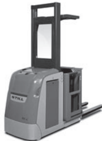
EK-X Einfachhubgerüst Bauhöhen 2.000/2.500 mm
