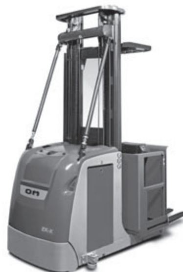
EK-X Castello telescopico altezza ingombro 2.400/2.900 mm
