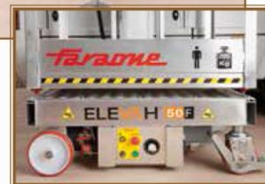
La macchina senza stabilizzatori può arrivare ad un'altezza di lavoro massima di 3,8 m, il tutto in modo automatico grazie ai sensori che rilevano l'altezza del cestello.
