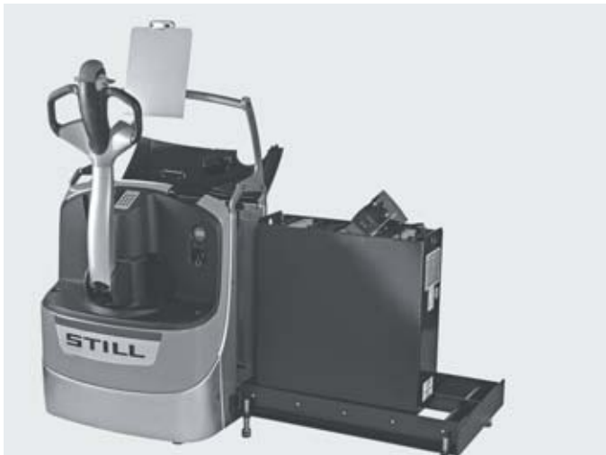
Disponibilité maximale grâce au changement latéral de batterie
