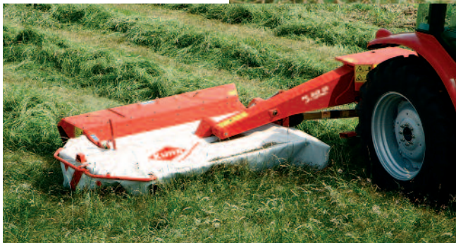
Die Mäheinheit verfügt über einen großen vertikalen Pendelweg, was auch bei großen Arbeitsbreiten einen tadellosen Schnitt ergibt.
