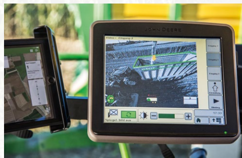
De bestuurder heeft een duidelijk zicht op de lading van de aanhanger
