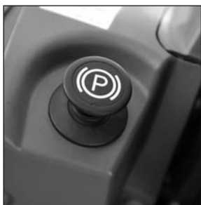
Pohodlné ovládání parkovací brzdy tlačítkem
