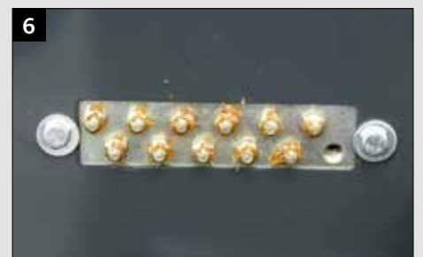
6 Zentral angeordnete Schmierbänke für die Walzenlager
