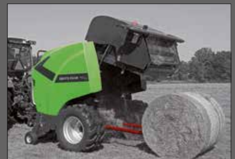
Der Auswerfer registriert, wann der Ballen die Presse verlassen hat. Die Heckklappe öffnet nur so weit wie nötig. Die Heckklappe schließt automatisch
