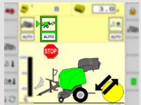
Ansicht zur automatischen Heckklappenbetätigung
