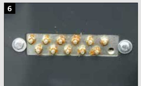
6 Zentral angeordnete Schmierbänke für die Walzenlager
