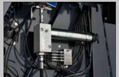
Automatisches Schmiersystem für die Walzenlager
