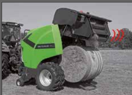
Die Heckklappe öffnet automatisch
