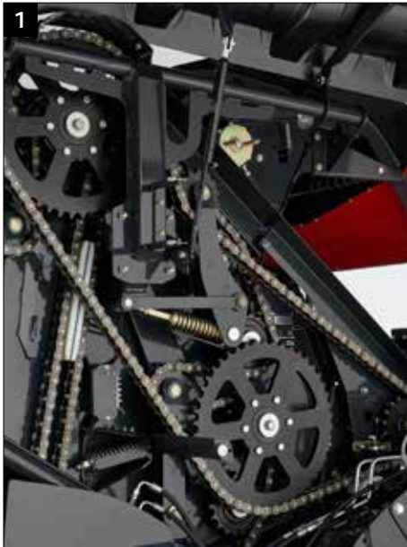
1 Robuster Antrieb mit hochwertigen IWIS-Ketten
