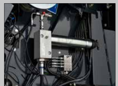
Automatisches Schmiersystem für die Walzenlager
