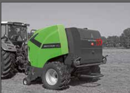
Während der Netzbindung gibt die Presse visuelle und akustische Signale aus
