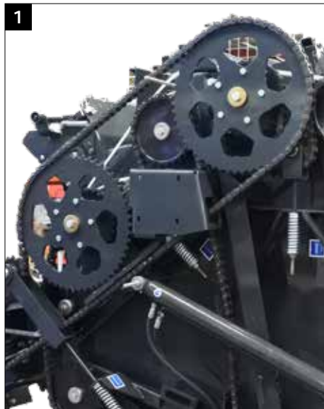
1 Einfacher Antrieb mit nur 3 Hauptketten
