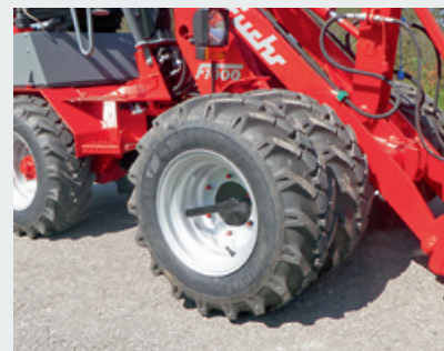
Zwillingsräder mit Schnellverschluss.
