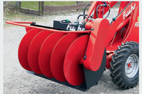
Futterräumschnecke hydraulisch angetrieben.
