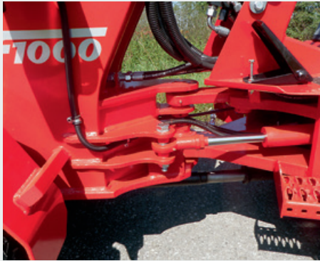
Überdimensionierte Knickpendellenkung mit doppelt gelagerten Gelenken für mehr Stabilität, große Standsicherheit und hohe Einschlagwinkel.
