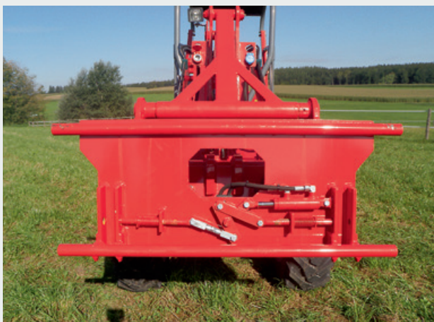
EURO-Aufnahme (mit oder ohne hydraulische Werkzeugverriegelung).
