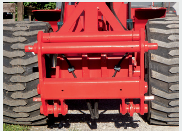
EURO-Aufnahme System FUCHS mit hydraulischer Werkzeugverriegelung für extremste Einsätze.
