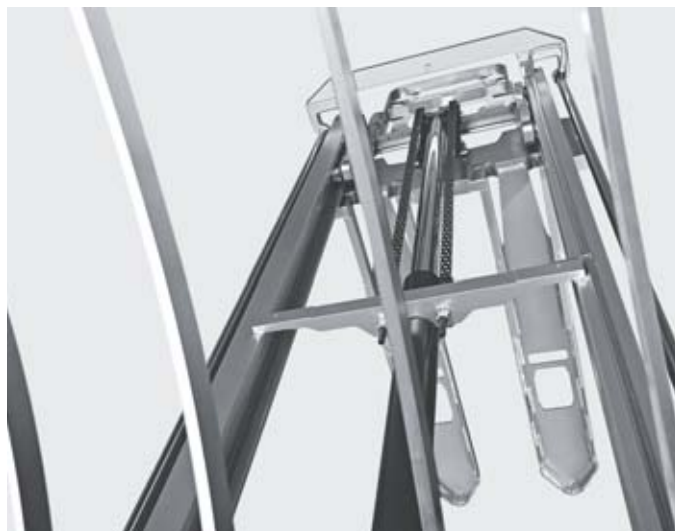
Vynikající výhled na hroty vidlic umožňující vysoký výkon překládky a rychlé najždění do palet
