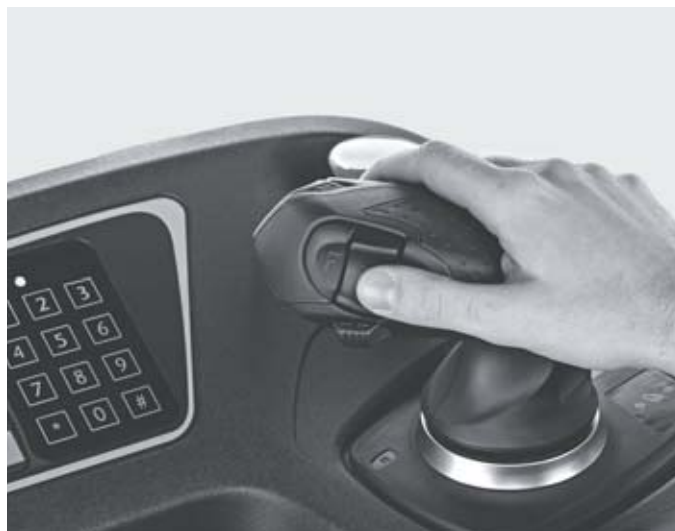
Individuální ovládání zdvihu, spouštění a pojezdu bez přehmatávání díky Joystick 4Plus
