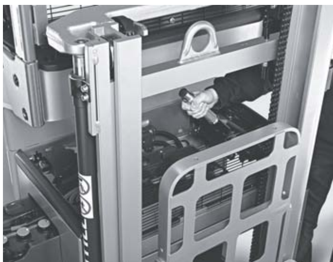
Sériově dodávaná boční výměna baterie zajišťující maximální disponibilitu a ergonomii
