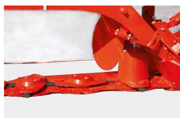
OPCIONAL: RUEDA DE HILERADO INTERIOR PARA LAS GMD 24 Y 240
