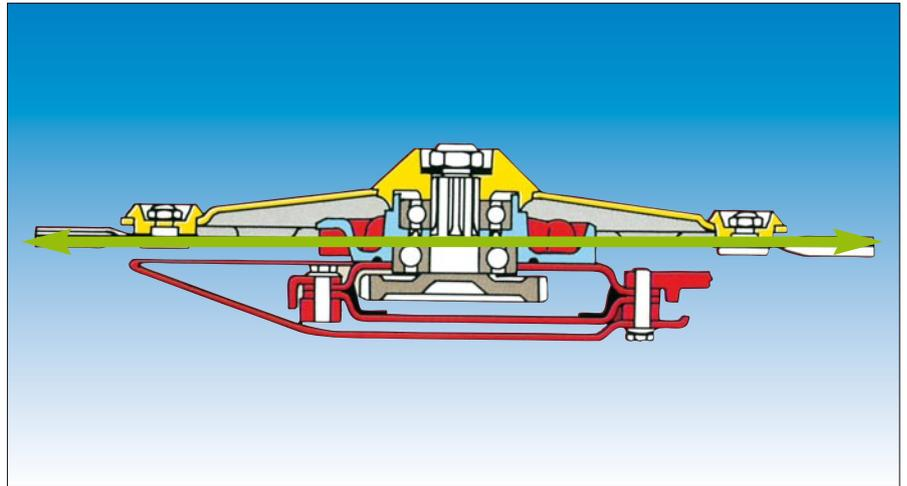
Die Lager sind symmetrisch zur Kraftlinie der Mähscheiben angeordnet. Das ergibt einen hervorragenden Kraftausgleich und verlängert die Lebensdauer der Lager.
