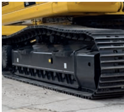
Laufrollenschutz über die gesamte Laufwerkslänge (Option)
