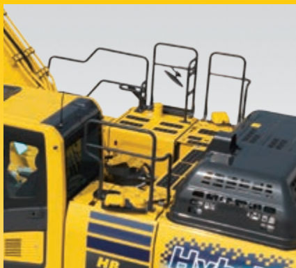
Handläufe und rutschfeste Oberflächen
