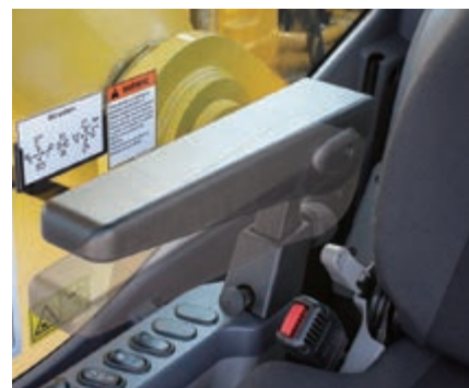
Armstütze mit einfacher Höhenverstellung
