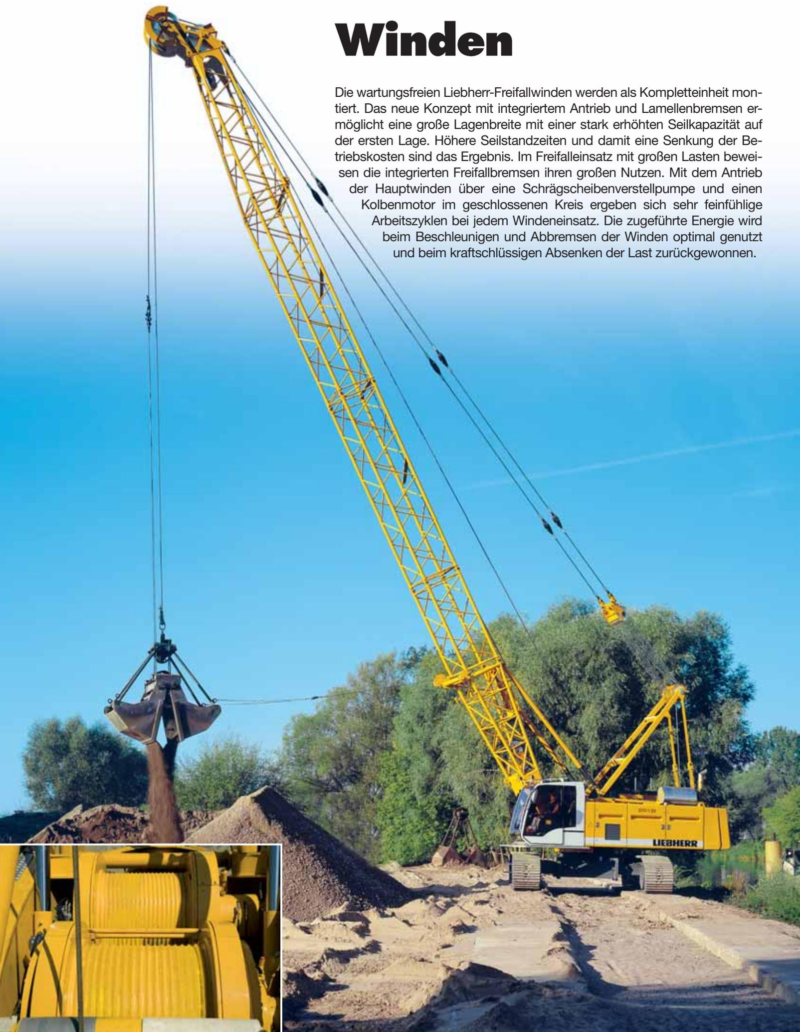
Hochdruckgeregelte Verstellölmotoren sorgen durch eine automatische Anpassung der Geschwindigkeiten an den Seilzug schon im Teillastbereich für die volle Ausnutzung der installierten Motorleistung.
