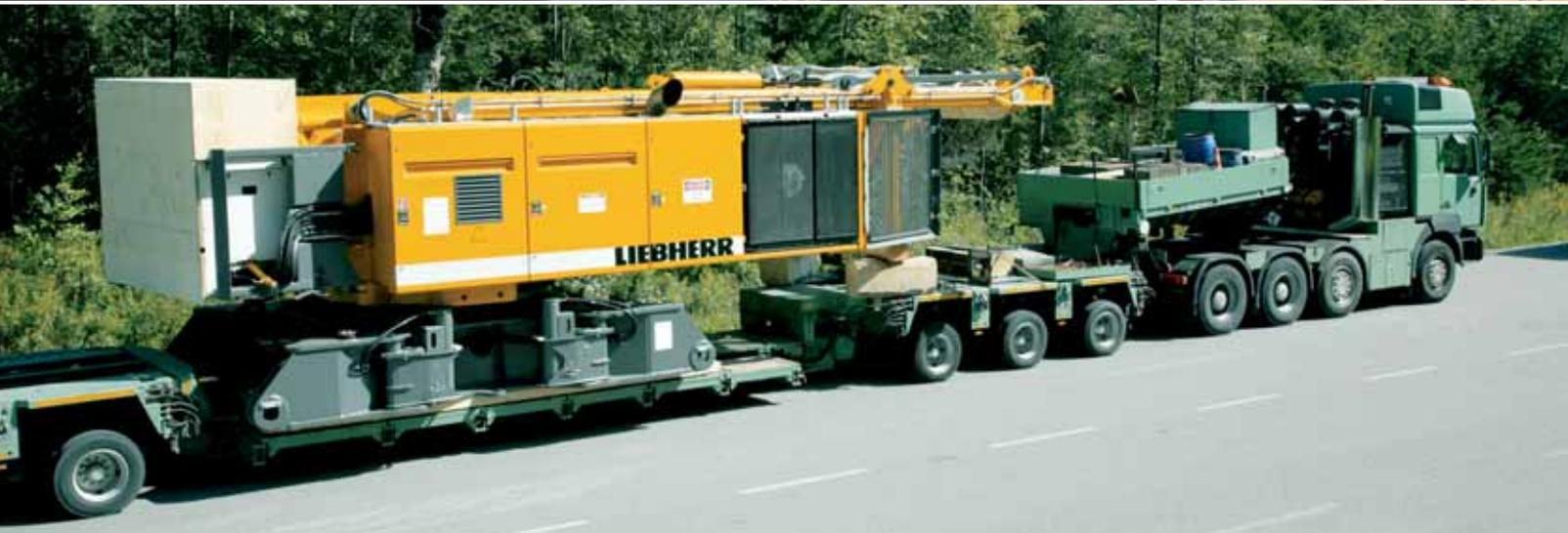
Zur Verringerung des Transportvolumens können außerdem die Nadelauslegerteile raumsparend in die Hauptauslegerteile eingeschoben werden. Die Ballastplatten finden dank ihrer geringen Bauhöhe unter den Auslegerteilen Platz. Alle Haltestangen und Bolzen verbleiben beim Transport in den dafür vorgesehen Halterungen.
