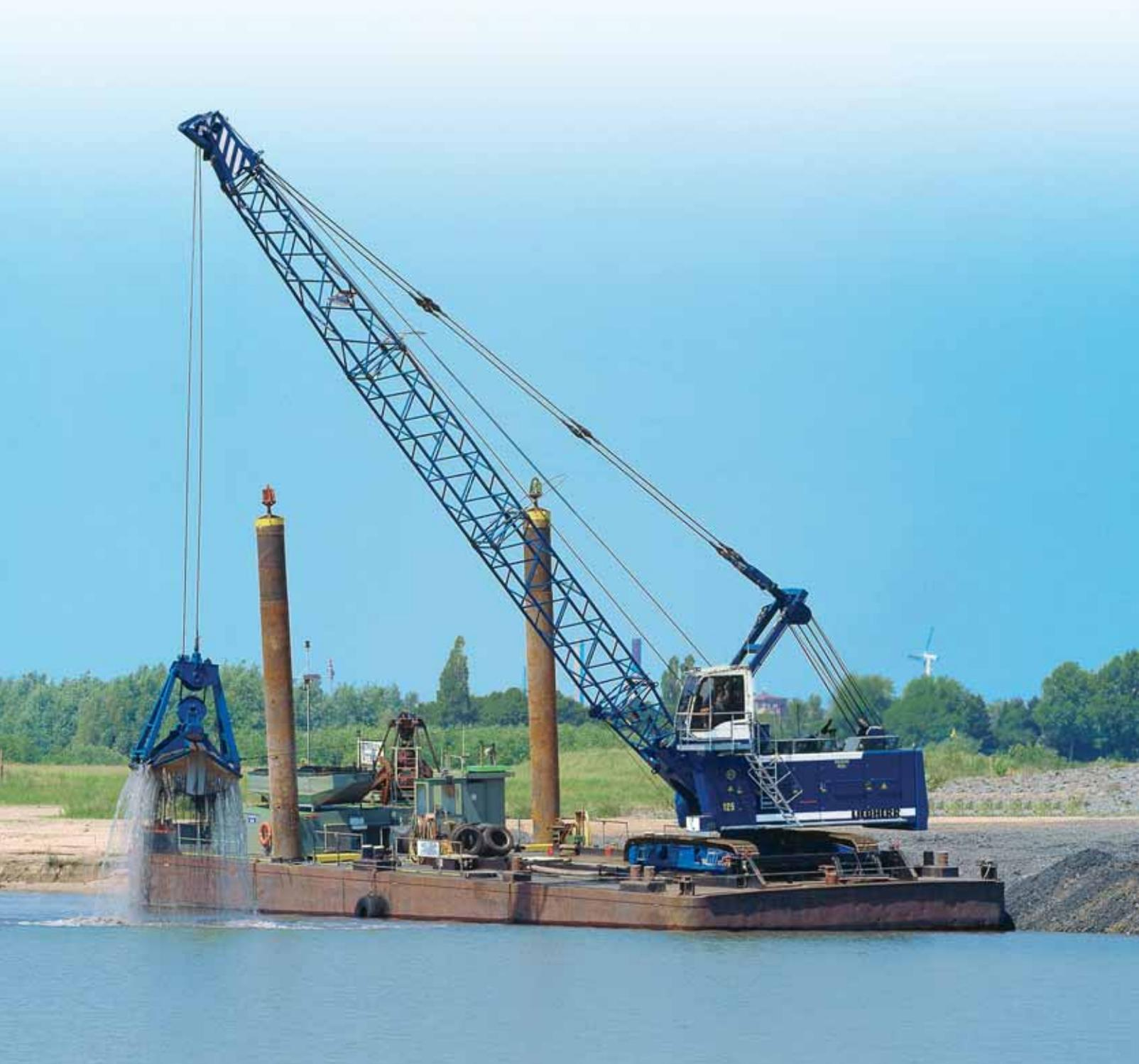
Hydraulische Freifallbremsen ermöglichen beim Arbeiten mit Schlitzwandgreifer ein präzises Handling des Greifers z. B. beim Entleeren direkt auf den LKW. Die elektronischen Multifunktionsmeisterschalter unterstützen das feinfühliges Steuern des Greifers. In diesen Meisterschaltern sind alle während des Betriebes benötigten Bedienelemente sowie die Motordrehzahlverstellung integriert. Der Fahrer kann sich voll auf seinen Arbeitsbereich konzentrieren.
