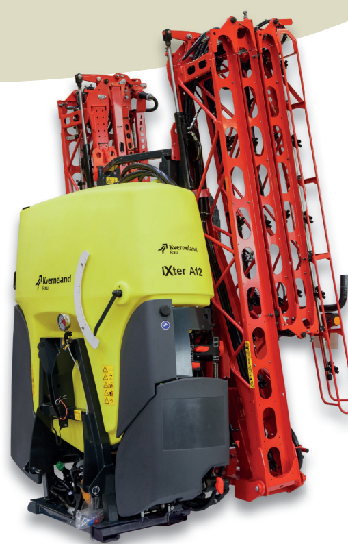
HC Barras de acero con plegado vertical
