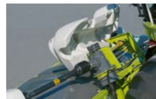
Sprzęgło hydrauliczne do opóźnionego włączenia ślimaka i belki tnącej
