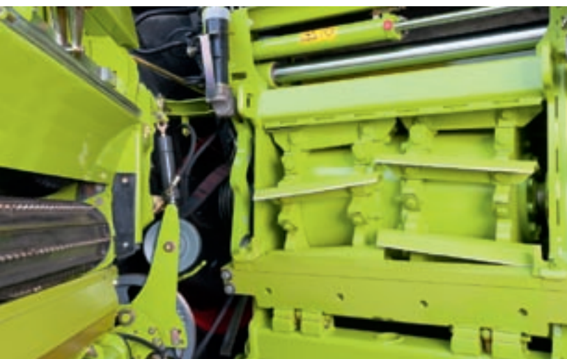
Montaggio semplice e variabile dei coltelli
