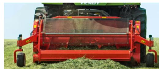
La trasmissione a variazione continua della testata permette di regolare la velocità della testata per adattarla con precisione alle condizioni di raccolta.
