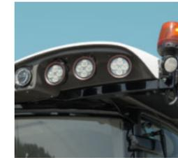
3 paia di fari di lavoro sul tetto, abbagliante anteriore sul tetto, faro laterale e lampeggiante.
