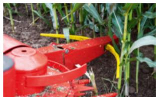
Grazie ai sensori delle file posti sulle punte della testata a mais, la Katana è in grado di operare con una precisione al centimetro e in modo completamente automatico.
