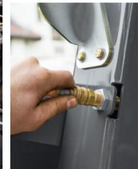
Tre prese per aria compressa integrate consentono la pulizia a secco delle parti principali della macchina direttamente in campo.
