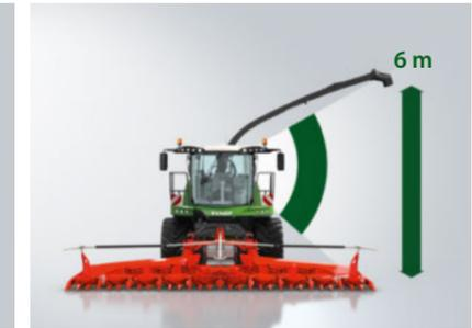
Anche con un'altezza di scarico fino a sei metri, l'operatore ha sempre il tubo completamente in vista. Se lo si desidera, il tubo di scarico può essere allungato per consentire un riempimento ottimale del rimorchio anche con utilizzo di testate larghe.
