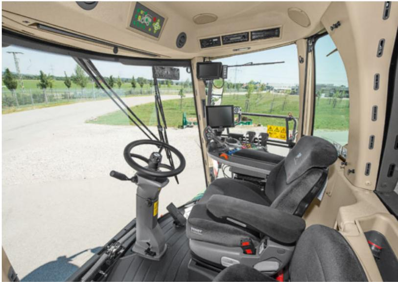
La cabina Visio5 è concepita per offrire una visibilità ottimale, una perfetta ergonomia e comando sulla postazione di lavoro. Grazie allo speciale profilo del tetto, l'operatore ha sempre il tubo di lancio in vista. Gli impianti di climatizzazione e riscaldamento automatici garantiscono un clima di lavoro piacevole.
