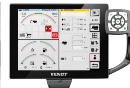
Oltre all'area lavorata misurata in ettari, la nuova funzione di misurazione registra anche la sostanza secca e la produttività.
