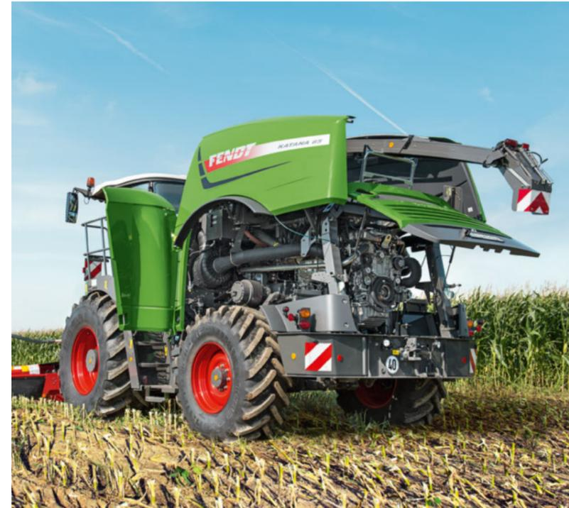
I cassettei di stivaggio e della batteria, ben accessibili sulla parte posteriore del veicolo, offrono spazio sufficiente, ad esempio per la cassetta degli attrezzi opzionale.
