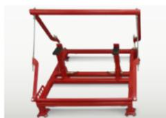
Carrello di manutenzione per un montaggio e smontaggio semplice del gruppo trinciante, per operazioni di pulizia e manutenzione.
