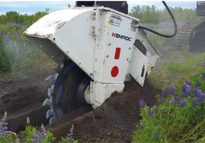
▲ In Island fräst dieses **DMW220** einen 70 cm tiefen und 15 cm breiten Kabelgraben in das Lavagestein. Die Fräsleistung liegt bei ca. 30 Metern pro Stunde.
