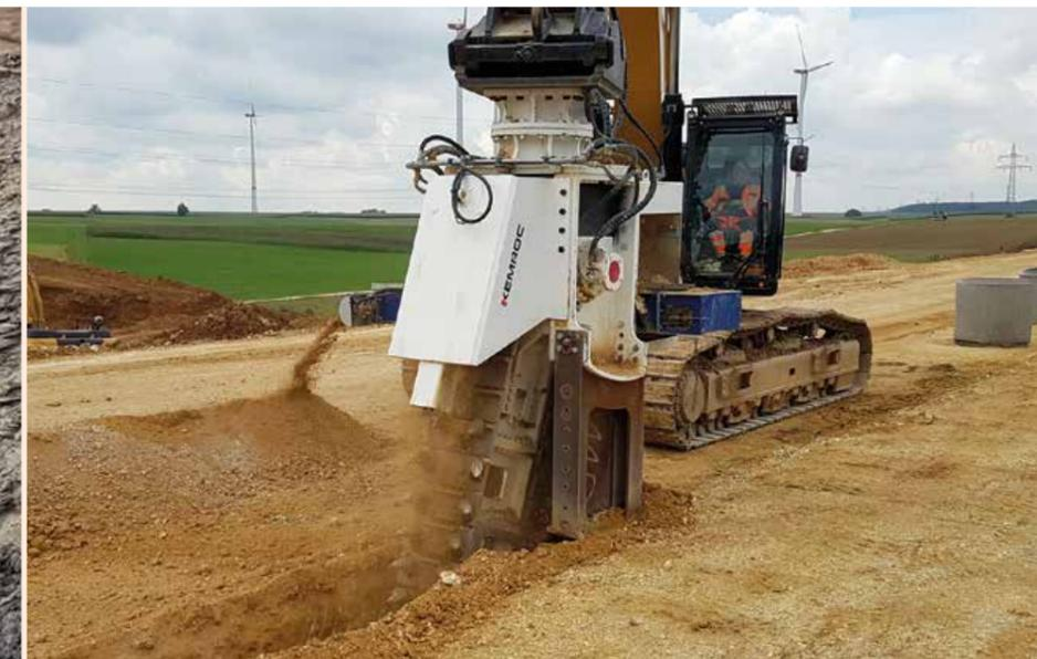
▲ Dieser Trencher **ETR 3** fräst einen 60 cm breiten Graben verschiedener Tiefen in weichen Kalksteinböden mit einer einaxialen Druckfestigkeit von 60 MPa. Die Maschine arbeitet dabei neben dem Fahrwerk des Baggers. Die Fräsgeschwindigkeit beträgt 50 m/h.
