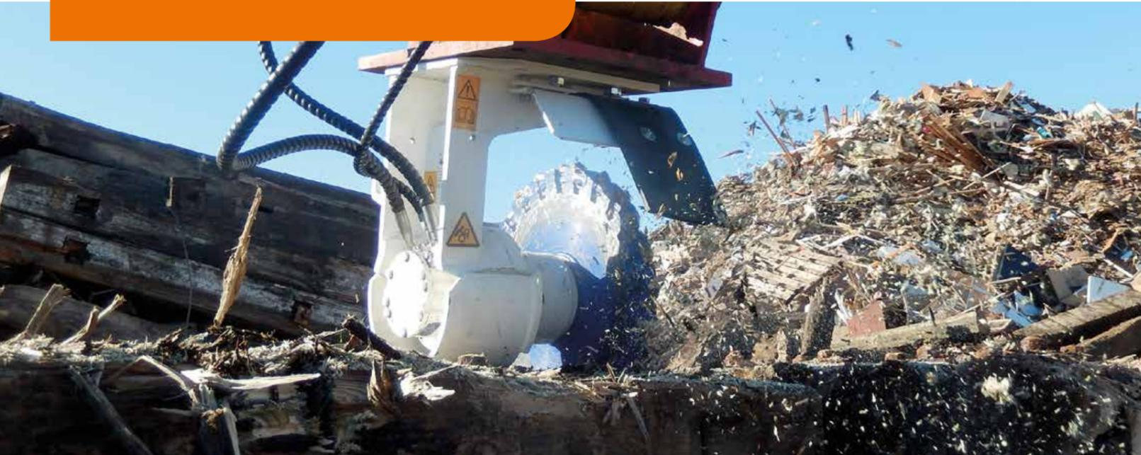
◀ Mit einer **ES 45 HD** werden alte Holzbalken schnell und effizient zersägt.
