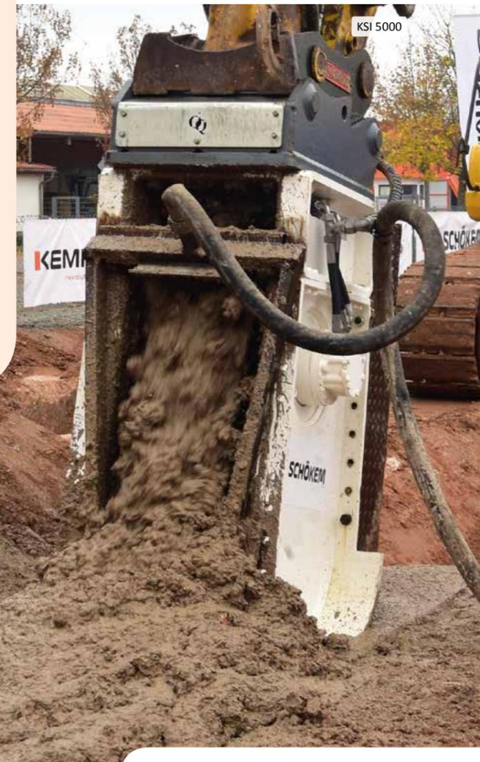
Die Injektionsmaschinen der Serie KSI sind in Zusammenarbeit mit einem deutschen Spezialtiefbau-Unternehmen entstanden und bilden die Grundlage für das SCHÖKEM-Verfahren.
