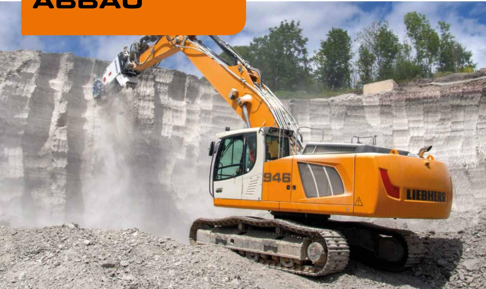
▲ Kraftvoller und effektiver Gipsabbau mit einer **EK 140** mit 900 mm Arbeitsbreite an einem Liebherr 946. Die Abbauleistung beträgt ca. 110 Tonnen pro Stunde.
