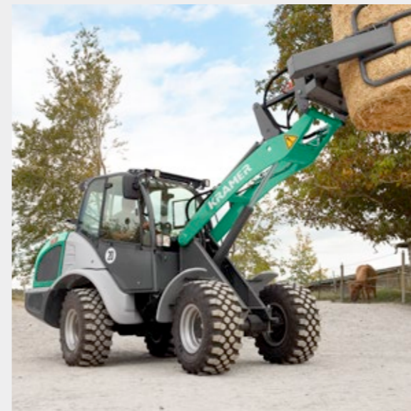
Hundeganglenkung für präzise Positionierung
