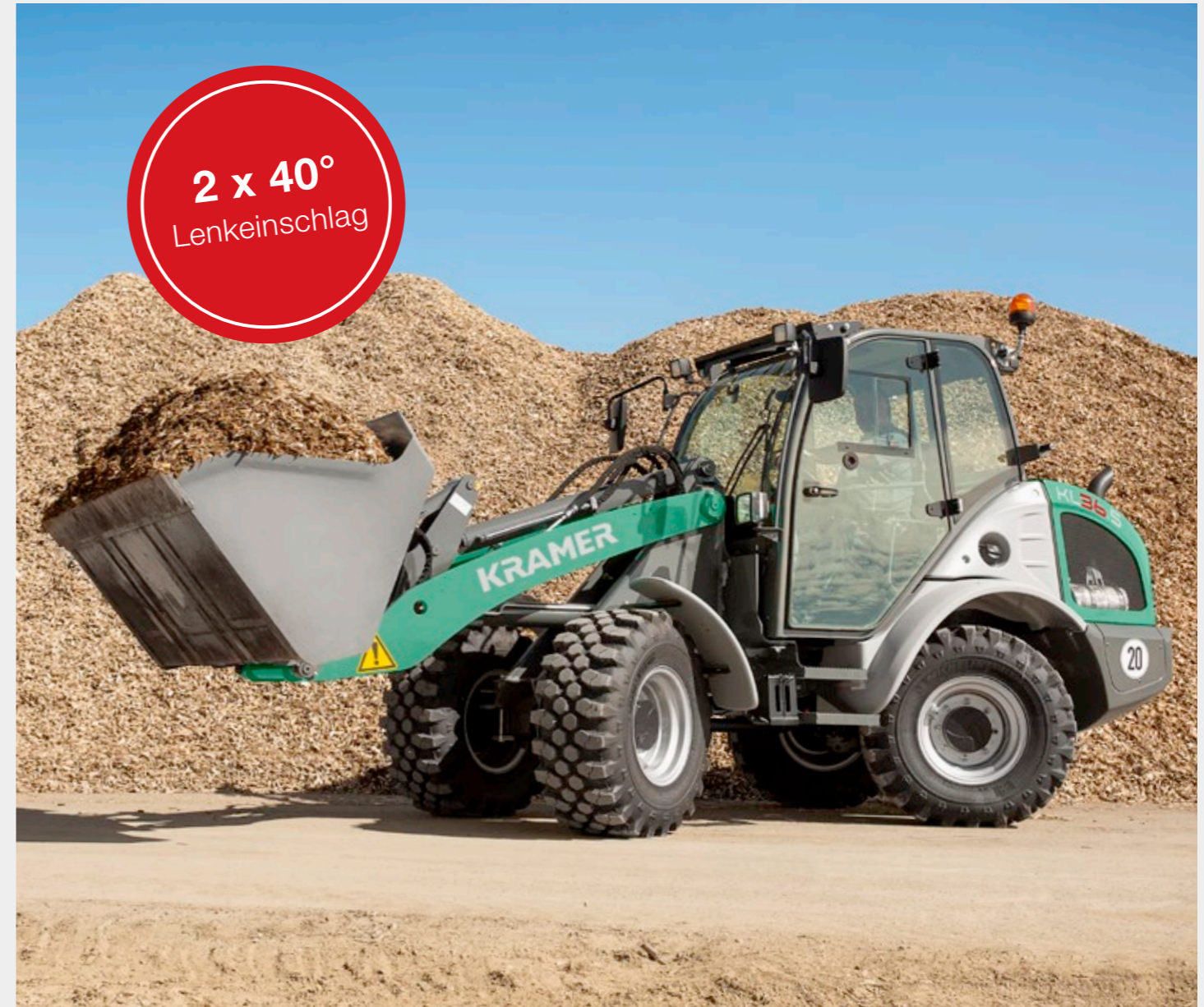
Allradlenkung besonders wendig bei eingeschränkten Platzverhältnissen
