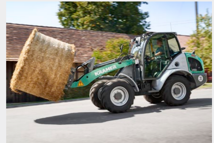
Vorderachslenkung für erhöhte Sicherheit bei schnellen Transportfahrten
