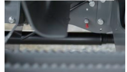
Schmierleitung Pendelbolzen an der Hinterachse (Serie)
