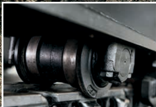
Entièrement repensé, le galet inférieur empêche la boue de pénétrer dans la machine et de l'endommager.
