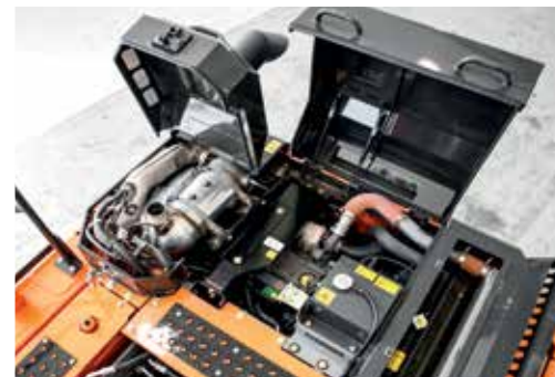
Accesso rapido al compartimento motore.
