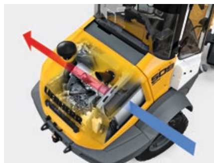
Sistema de refrigeración L 507/L 509
