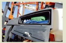
KUHN nimmt den Anwenderschutz in Zusammenhang mit Feldspritzen sehr ernst. Um die Gesundheit des Anwenders nicht zu gefährden, hat KUHN die Feldspritze LEXIS mit zwei Staufächern ausgerüstet, in denen die persönliche Schutzausrüstung aufbewahrt werden kann. So hat der Anwender alles schnell zur Hand, bevor er mit Pflanzenschutzmitteln hantiert.
