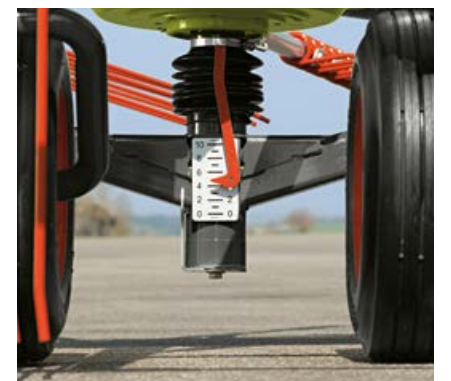
Adaptation en souplesse avec les échelles graduées pour régler la hauteur de travail.
