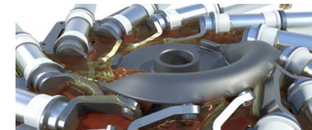
Came à bain d'huile : inusable, fiable, sans maintenance.
