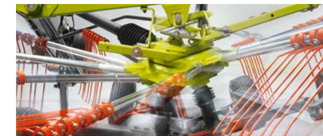
Articulation cardanique des rotors : les rotors s'adaptent aux reliefs du terrain, indépendamment du tracteur.
