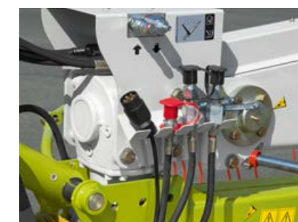
Commande séquentielle hydraulique de série pour le réglage temporisé du relevage et de l'abaissement des rotors avant et arrière.
