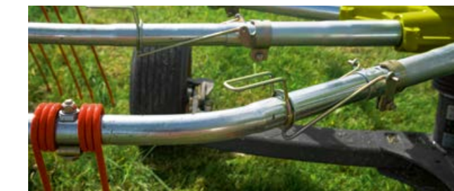
Des chocs sans dégât : en cas de collision, les bras plient en un point prédéfini.
